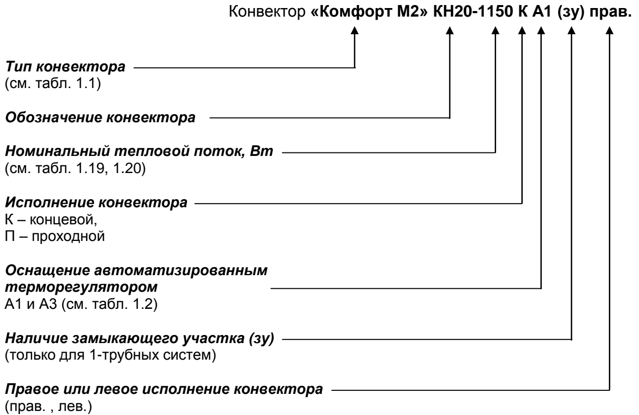
Рис. 1.59. Схема условных обозначений настенных конвекторов с кожухом «Комфорт М2», используемых при заказе
