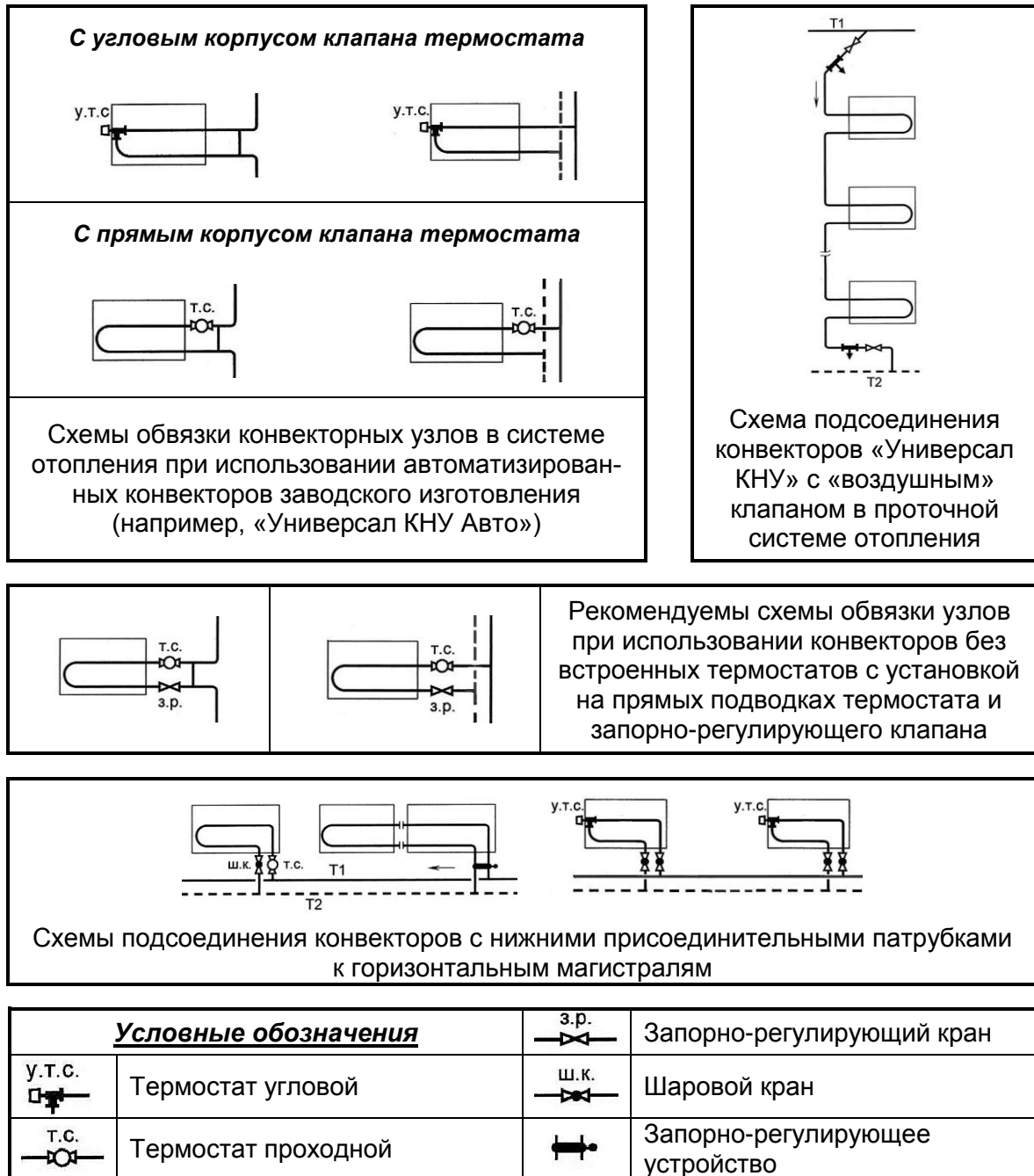
Рис. 1.61. Схемы узлов обвязки конвекторов АО «Завод Универсал», используемых в системах отопления
